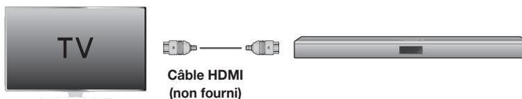
1. Utilisez un câble HDMI pour connecter le téléviseur prenant en charge ARC à la Soundbar.
