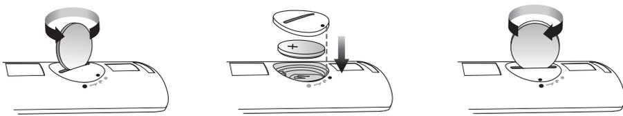
1. Utilisez une pièce de monnaie adaptée pour tourner le couvercle de la batterie de la télécommande dans le sens inverse des aiguilles d'une montre pour le retirer comme indiqué sur la figure ci-dessus.
