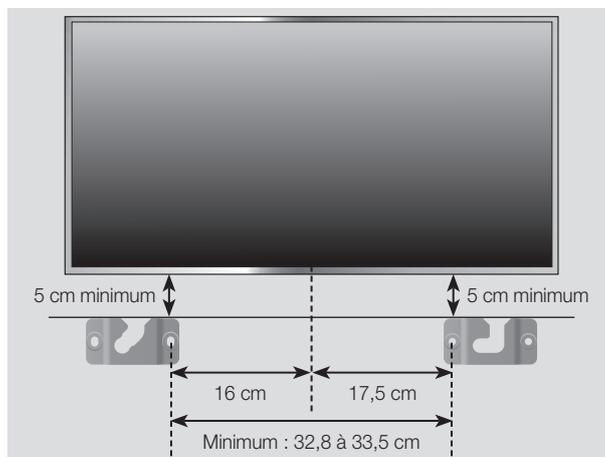
1. Placez la "Fixation rurale Gauche" sur la surface souhaitée du mur, tout en s'assurant qu'elle soit parallèle au sol comme indiqué ci-dessus. Ensuite, insérez une vis dans l'orifice à son extrémité droite.
